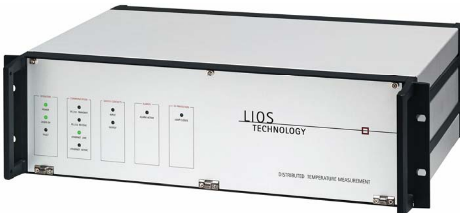
Bild 4.4: Ansicht des DTS-Systems
